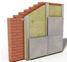
Играет ключевую роль в тепловой защите и звукоизоляции объекта. Состоит из одного или двух слоев.
